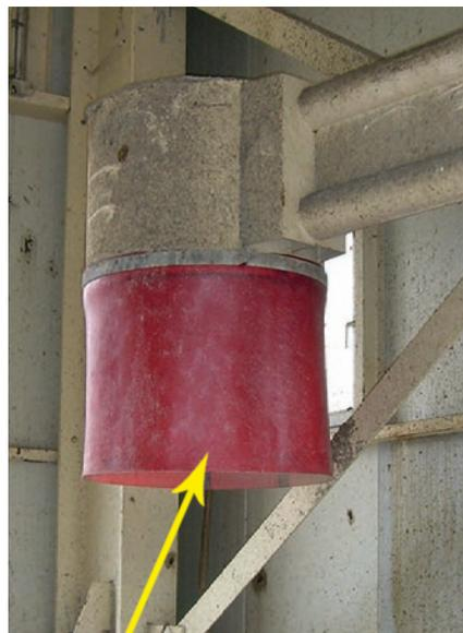
▲ Der PUCESST -Auslaufschlauch: Bei dieser Mischanlage wurde am Schwenkarm für Selbstabholer ebenfalls ein PUCESST Auslaufschlauch angebracht.
