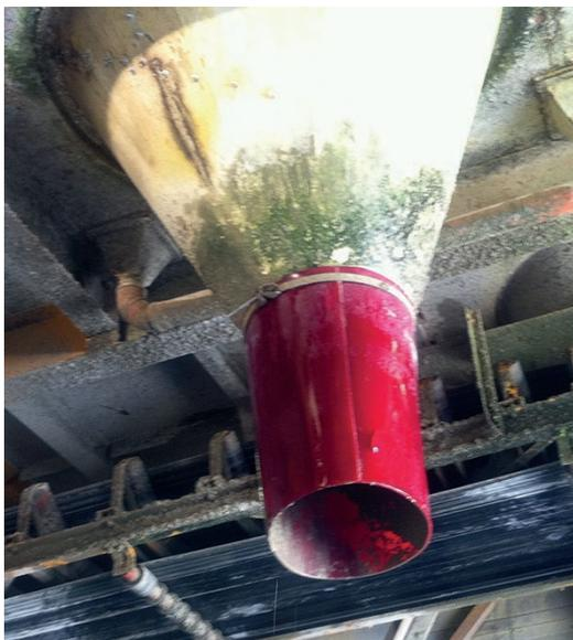
▲ Ein PUCESST-Auslaufschlauch nach einer Standzeit von ca. 100.000 m<sup>3</sup>
