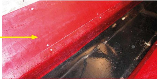
Die PUCEST Materialführung für Förderbänder schützt die Seitenführung der Bänder und gewährleistet einen gleichmässigen Materialfluss.
