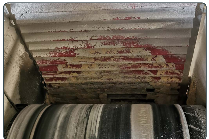
SZ-Platten halb hängend im Prallbereich eines Förderbandes
