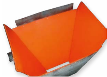
Trichterauskleidung aus PUCEST Platten mit Lochblecheinlage und Antihaft Effekt
