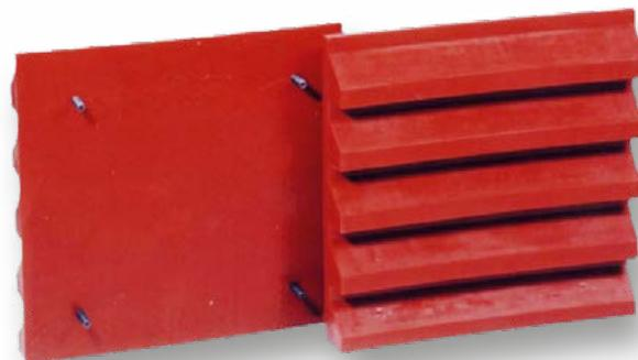
**Das Standardmass der Platten ist 500 mm x 500 mm bei einer Stärke von 50 mm. Die Shorehärte kann nach Bedarf zwischen A 50-95°Shore gewählt werden. Die Prallplatten lassen sich mittels der Stehbolzen auf der Rückseite schnell und einfach montieren.**
